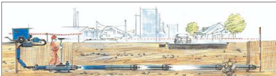
Fig. 12: Siluro - attraversamento stradale
