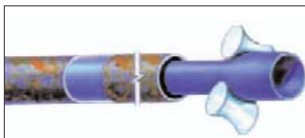
Fig.15: Deformazione radiale del tubo attraverso l'impiego di rulli nel caso di Swage-lining.
