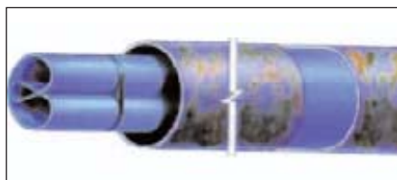
Fig.16: Deformazione a 'C' nel caso Folded-lining
